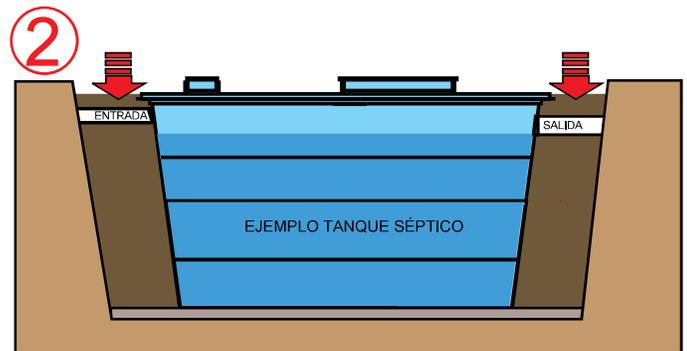
Una vez instalados y nivelados los elementos deben ser llenados en dos etapas:
